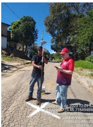
Figura 1. Coleta de coordenadas de ponto de apoio com GNSS Geodésico. Fonte: próprio autor.
