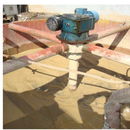
Figura 3 - Processo de mistura na etapa de floculação
