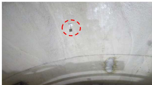
Figura 6. (a) Marco refletivo instalado no teto do túnel para medição de convergência e (b) Fissurômetro para acompanhamento de fissuras.
